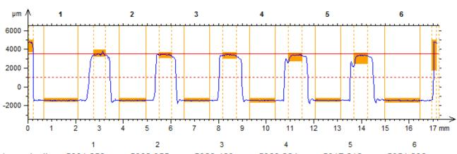
Maximum depth 5031.259 μm 5039.055 μm 5023.463 μm 5069.264 μm 5017.616 μm 5051.236 μm Mean depth 4985.369 μm 4984.381 μm 4985.567 μm 4987.931 μm 4976.670 μm 4991.364 μm
